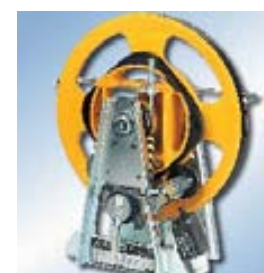
3 Ограничитель скорости Осуществляет мониторинг скорости и запускает ловитель в случае необходимости. Ограничитель скорости устанавливается на приводной раме.
