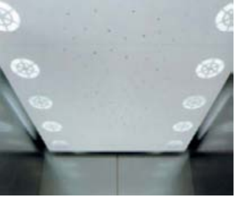
CEI 7 – Circle Segments Эффект внутренней подсветки потолка достигается применением двух рядов двухлучевых люминесцентных ламп, а также высококачественного рассеивающего экрана.
